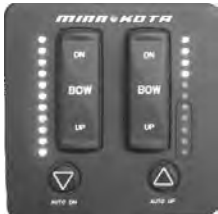
Port Trim Tab: 20° down Starboard Trim Tab: 6° down
